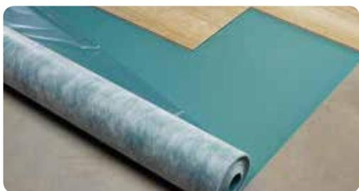
Sottopavimento con fibre minerali e poliuretano, certificato Classe al fuoco Bfl-S1, necessario per la Certificazione del pacchetto pavimento-sottopavimento in appoggio secondo norma europea EN 13501. Idoneo anche per pavimenti LVT.
